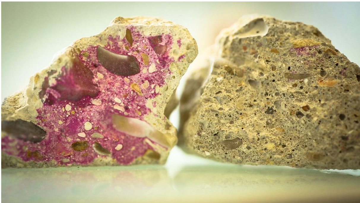
Figure 1. Etat de carbonatation (couleur après aspersion de phénolphthaléine) d'une section de granulats issus de plate-forme de recyclage, avant (à gauche – le pH du béton est très basique,
